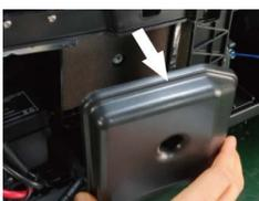
3. Nettoyez l'élément du filtre en mousse avec un solvant de nettoyage et laissez-le sécher à l'air. Mettez quelques gouttes d'huile sur le filtre.
