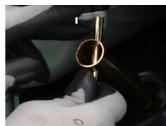
3. Vérifiez s'il y a des décolorations et retirez toute accumulation de dépôts de carbone. Vérifiez la couleur pâle ou brun modéré de la bougie d'allumage sur les noyaux en céramique autour de l'électrode centrale.
